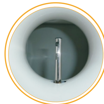
Fig 7 : Rotation du fil chaud ponctuel
