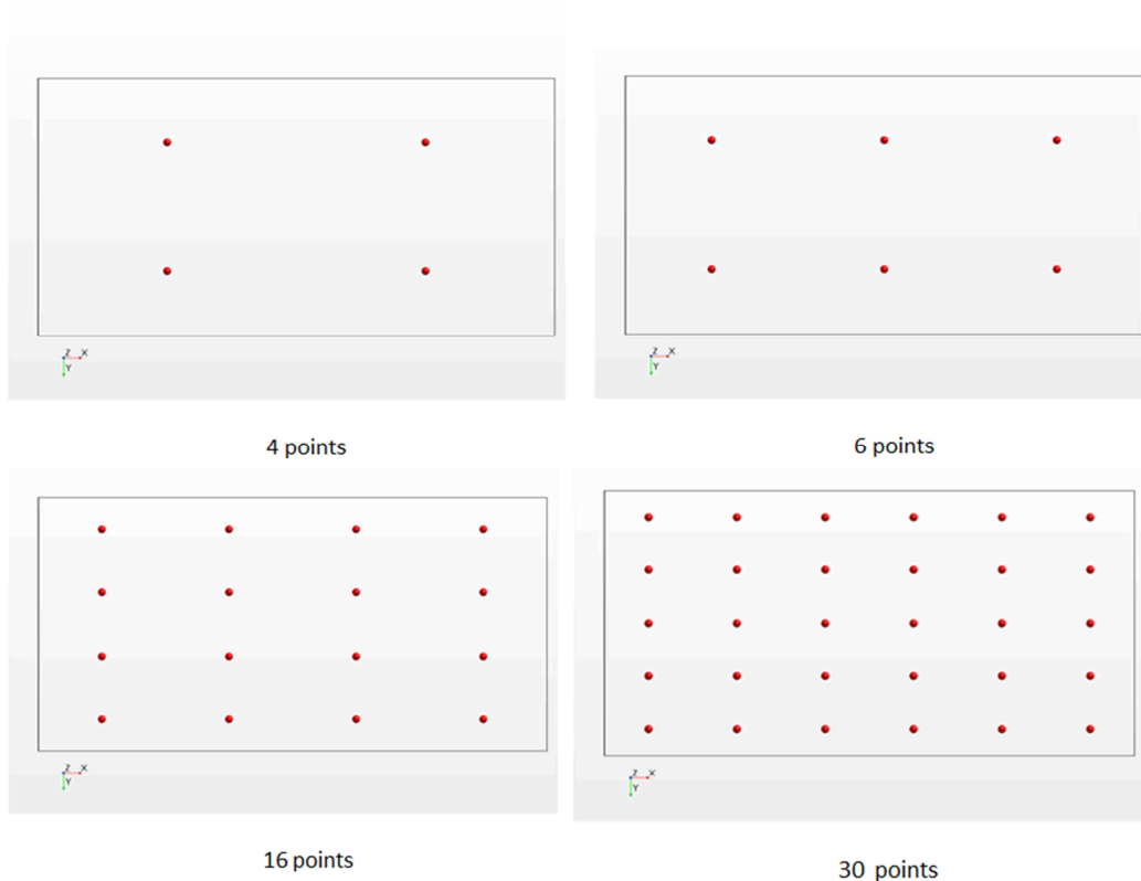
Figure 23 : Positions des points de mesure selon NF EN 12599 considérées dans la simulation
